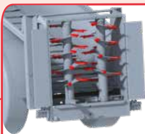
Verwisselbare en omkeerbare messen in HARDOX 450
