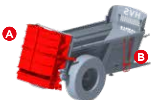
(A) Kap met dubbele deur (B) Ladder om in de laadbak te kijken
